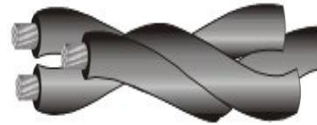
Cáp Triplex: kiểu các một đều bọc (All conductors are insulated)
