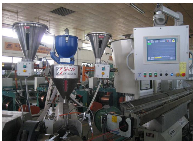
Hệ thống máy bọc vỏ dây điện SAMP – EXTRUSION (Italia)
